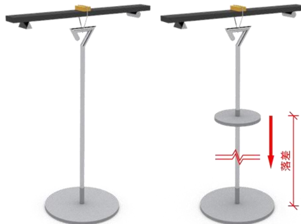
图-3 加载试验装置示意图 (左: 静载 (建议); 右: 冲击)
