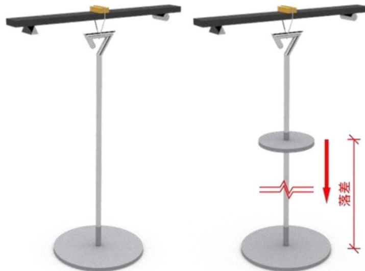
图4 加载试验装置示意图（左：静载；右：冲击）
